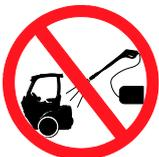
Besprühen Sie den Motorraum oder die Kühler niemals mit einem Hochdruckreiniger. Kühleradiatoren und elektrische Geräte, deren Anschlüsse und Isolatoren sowie die Batterie könnten beschädigt werden. Verwenden Sie kaltes oder warmes Wasser, um andere Teile des Laders zu reinigen. Verwenden Sie niemals heißes Wasser (über 70 °C).
