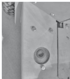
Bei Maschinen mit Kabine L befindet sich der Tank hinter dem linken Vorderrad und die Einfüllöffnung auf dem Trittbrett.
