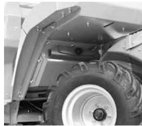
Die Knickgelenksperre befindet sich über dem Knickgelenk, unterhalb der Sitzfläche, und wird mit einem Bolzen befestigt.
