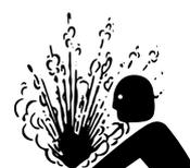
**Gefahr des Berstens von Hydrauliköl – Trennen Sie Hydraulikspeicher vor der Wartung** (Nur Lader, die mit optionalem Smooth Drive-System ausgestattet sind). Wenn der Lader mit der Option „Sanfter Antrieb“ ausgestattet ist, wird ein Druckspeicher an den Hydraulikkreislauf des Hubarms angeschlossen. Trennen Sie keine hydraulische Komponente, bevor der Speicher vom Stromkreis getrennt und der Restdruck abgelassen wurde.
