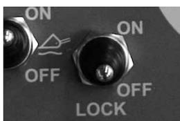
**VERRIEGELUNG AUS:** In diesem Modus fließt das Hydrauliköl nach und nach von Motor zu Motor. Die Räder können sich freier drehen und der Lader hinterlässt weniger Reifenspuren auf weichen Oberflächen.
