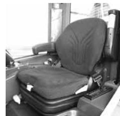
Der Sitz ist mit einer Heizung ausgestattet. Der Heizungsschalter befindet sich auf der linken Seite der Rückenlehne. Darunter befindet sich die Einstellung der Lendenwirbelstütze.
