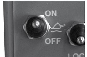
**HINWEIS:** Der Schalter ist auf dem Armaturenbrett installiert, auch wenn die Option Niveaueingleich nicht auf dem Lader installiert ist. Das Vorhandensein des Schalters bedeutet nicht, dass die Optionen „Niveaueingleich“ oder „Sanfter Antrieb“ vorhanden sind.
