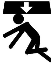
**Quetschgefahr – Sichern Sie stets die Hubarmstütze am Hubzylinder, bevor Sie sich unter den Hubarm oder ein Anbaugerät begeben.**
