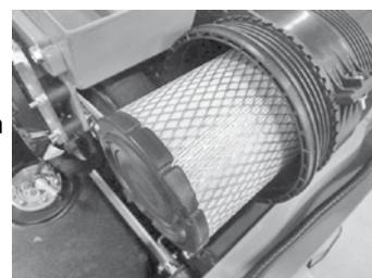
1. Drücken Sie die Gummidichtung am Filtergehäusedeckel zusammen, um Wasser und Schmutz aus dem Filter abzulassen.
