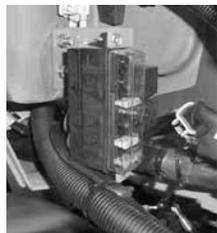
Bei der Kabine DLX mit Klimaanlage befinden sich zusätzliche Sicherungen im Sicherungskasten in der Nähe des Gashebels, die durch Abnahme der rechten Seitenverkleidung außerhalb der Kabine zugänglich sind.
