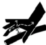
**Hantieren Sie niemals mit Hydraulikkomponenten, wenn das Hydrauliksystem unter Druck steht – Gefahr des Eindringens von Hydrauliköl über die Haut.**
