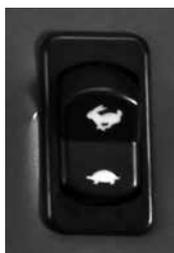
Der höhere Geschwindigkeitsbereich ist für längere Fahrten vorgesehen, bei denen keine hohe Zugkraft erforderlich ist.
