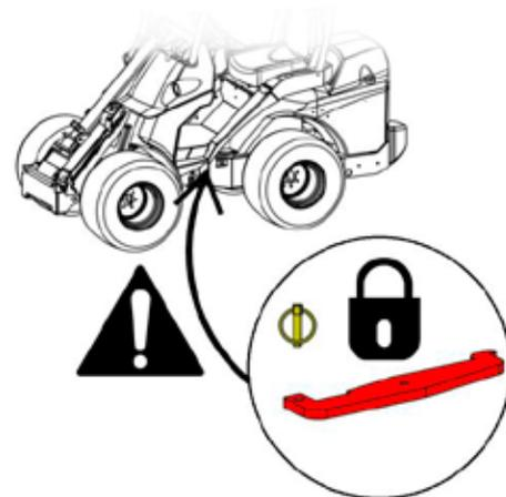
Vor dem Transportieren oder Anheben des Laders unbedingt die Knickgelenksperre verriegeln. Denken Sie daran, die Knickgelenksperre nach dem Transport zu entfernen und die Lenkung des Laders zu überprüfen.
